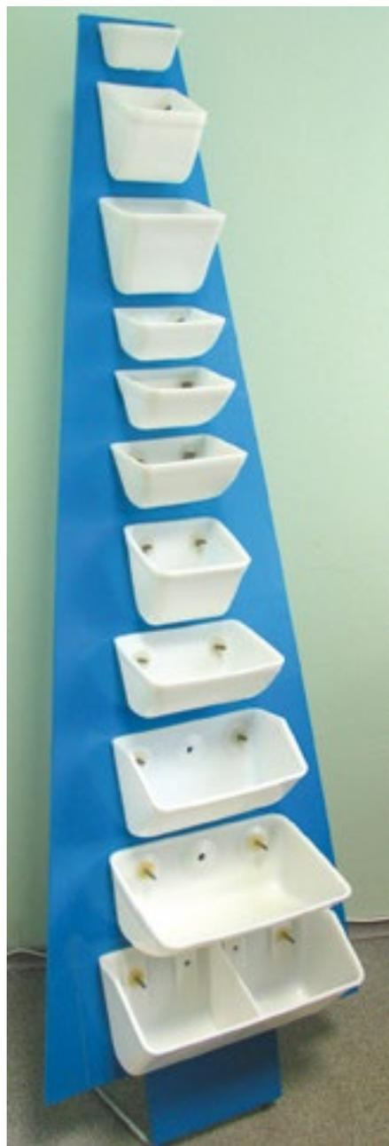
Вследствие меньшей массы полимерного ковша, снижается механическая нагрузка на норийную ленту и привод нории, что приводит к экономии электроэнергии на 15-20% и увеличению срока службы норийной ленты, уменьшению металлоемкости конструкции, сокращению стоимости ремонтно-монтажных работ за счет сокращения числа требуемых рабочих. Кроме того, полимерные
