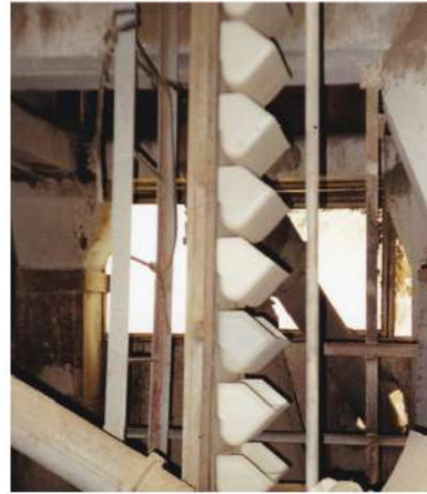
Примерные испытания на электростатическую искробезопасность полимерных нормальных ковшей для нории производительностью 175 т/ч. (Насеркевичевский КХП, 1997 год)
