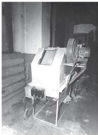
Стенд для определения показателей надежности и безопасности полимерных норийных ковшей (Кустанайская МИС, 1990 год)
