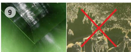
Введение в эксплуатацию бункеров до полного высыхания покрытия ухудшает его эксплуатационные свойства (рис. 10).
