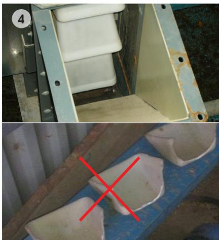
При неправильно отрегулированном натяжении норийной ленты ковши задевают о стенку норийной трубы, что значительно уменьшает срок их службы (рис. 5).
