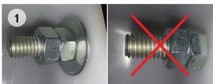
Чрезмерное затягивание гаек при креплении ковша на ленту и использование крепежа, не рекомендованного для монтажа полимерных ковшей (полусферических шайб, плоских шайб небольшого диаметра и т.п.), деформирует ковш вокруг крепежных отверстий (рис. 2).
